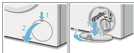
4. Sortir le flexible de vidange de sa fixation. Retirer le bouchon de fermeture, laisser le bain lessiviel s'écouler dans un récipient adéquat. Enfoncer le bouchon de fermeture et mettre le flexible de vidange en place dans la fixation.
