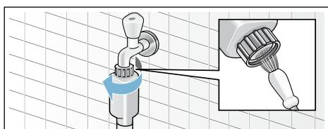
2. Nettoyage du filtre à l'arrière de l'appareil sur les modèles Standard et Aqua-Secure : Retirer le flexible au dos de l'appareil, Extraire le filtre avec une pince et le nettoyer.
