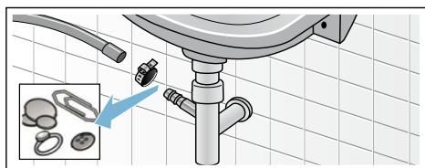
4. Remmancher le flexible d'évacuation et sécuriser le point de raccordement à l'aide du collier du flexible.
