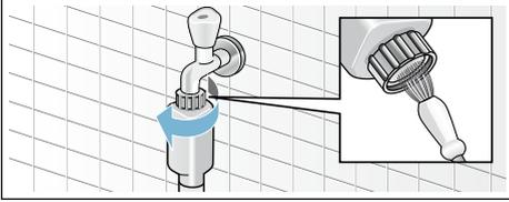
6. Standart ve Aqua-Secure modellerinde cihazın arka tarafındaki süzgeci de temizleyiniz: Hortumu cihazın arka tarafından çıkarınız, süzgeci bir pense ile dışarı çıkarınız ve temizleyiniz.
