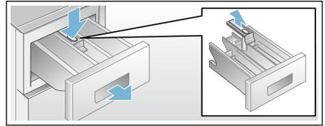
3. Deterjan alınan kabı ve parçayı su ve fırça ile temizleyiniz ve kurulayınız. Gövdenin içini de temizleyiniz.
