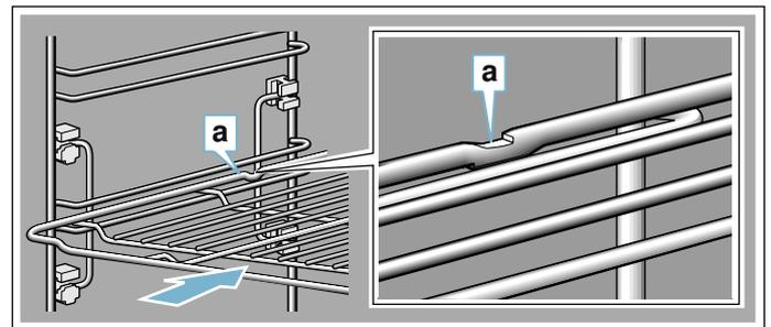
Durante l'inserimento dei pannelli, prestare attenzione che la tacca di arresto **a** sia nella parte posteriore e sia rivolta verso il basso. La smussatura dell'accessorio **b** deve essere rivolta in avanti verso la porta dell'apparecchio.
