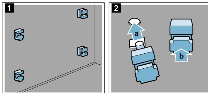
3. Agganciare il fermo posteriore con il gancio nel foro superiore **a** e inserirlo nel foro inferiore **b** (figura 3).
