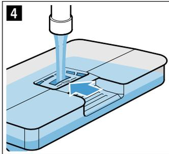
7. Abdeckung **a** wieder in die Öffnung am Wassertank einsetzen.
