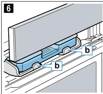
9. Blende langsam nach unten schieben, dann nach hinten drücken, bis sie vollständig geschlossen ist. Der Wassertank ist gefüllt. Sie können Betriebe mit Dampf starten.
