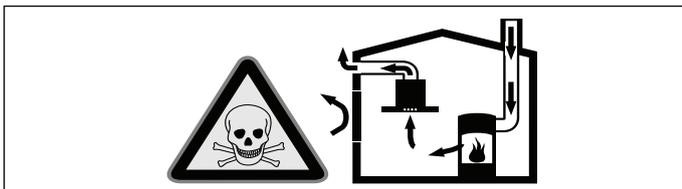
دستگاه‌های حرارتی وابسته به هوای محیط (برای مثال، بخاری‌های گازی، هیز می، نفتی یا زغالی، آبگرمکن‌های دیواری یا مخزن دار) هوای لازم برای احتراق را از محیطی که در آن نصب شده‌اند تأمین می‌کنند و گازهای حاصل از سوخت را از طریق یک سیستم تخلیه دود (برای مثال دودکش) به بیرون هدایت می‌نمایند.
