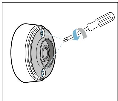
2. Het bovenste deel van de behuizing aftrekken. De oude batterij verwijderen. De nieuwe batterij plaatsen. Let erop dat de positieve en negatieve pool aan de goede kant zitten.
