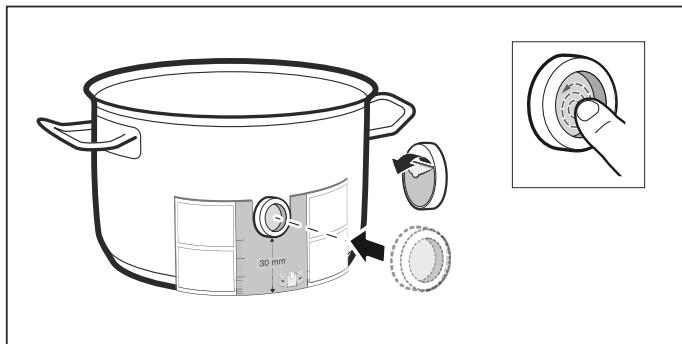
3. De siliconenpatch aandrukken, ook de binnenkant. De lijm heeft een uur nodig om goed uit te harden. Het kookgerei in deze tijd niet gebruiken of schoonmaken.
