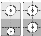
Le zone di cottura anteriore e posteriore, ciascuna con due induttori, possono essere utilizzate indipendentemente l'una dall'altra. Per ciascuna delle zone di cottura impostare il livello di cottura desiderato. Utilizzare solo un'unica stoviglia per ciascuna zona di cottura.
