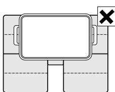
La stoviglia non può coprire contemporaneamente le due aree di cottura laterali e l'area di cottura FlexPlus.
