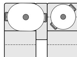
Per assegnare l'area di cottura FlexPlus alla relativa zona di cottura sollevare la stoviglia, selezionare un livello di cottura e ricollocare nuovamente la stoviglia.
