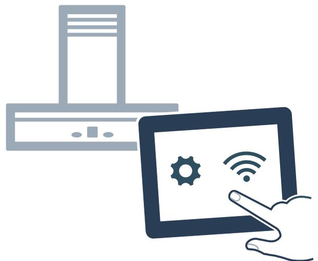
Wenn die Verbindung hergestellt wurde, verbindet sich die Dunstabzugshaube automatisch mit der Home Connect App. Die LED der Lüfterstufe 3 und das Symbol
