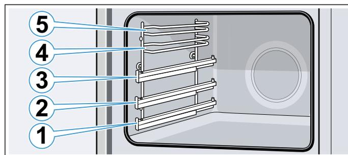
Aux niveaux d'enfournement 4 et 5, introduire l'accessoire toujours entre les deux barres de guidage d'un niveau d'enfournement.
