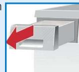
Si le voyant (**Réservoir d'eau de condensation**) clignote malgré le vidage → nettoyez le filtre du réservoir d'eau de condensation, pages 8/12.
