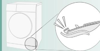
Le compresseur du sèche-linge produit de temps en temps un ronflement. Le volume et la hauteur du son peuvent varier en fonction des programmes sélectionnés et de l'avancement du séchage.
