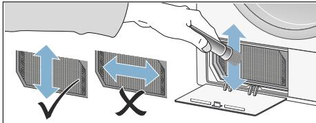
**Avvertenza:** Durante la pulizia prestare attenzione che le lamelle dello scambiatore di calore non siano piegate o danneggiate.
