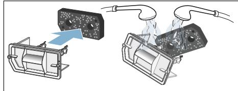
8. Asciugare il materiale filtrante strizzando l'acqua.
