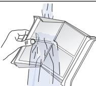
7. Asciugare i filtri per lanugine, chiuderli e reinserire il filtro per lanugine a due componenti.
