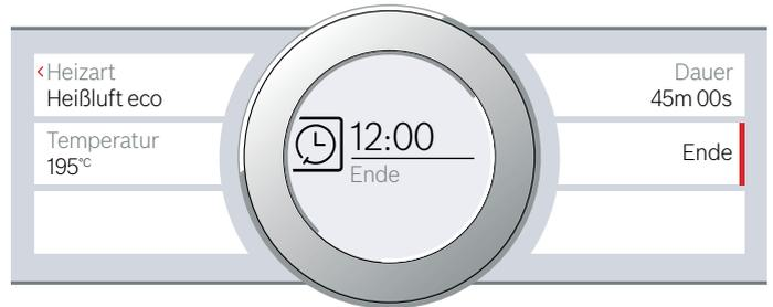
5. Mit Taste start/stop ▶ starten. Im Display steht die Uhrzeit, zu der das Gerät startet.
