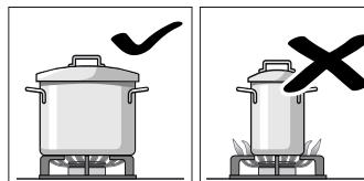
Χρησιμοποιήστε σκεύη κατάλληλου μεγέθους για κάθε καυστήρα.
