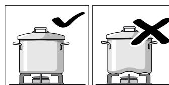
No utilice recipientes deformados que se muestren inestables sobre la placa de cocción. Los recipientes podrían volcar. Utilice solo recipientes de base plana y gruesa.
