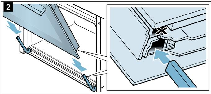
3. Gerätetür ganz öffnen. Beide Sperrhebel wieder zuklappen (Bild **3**).
