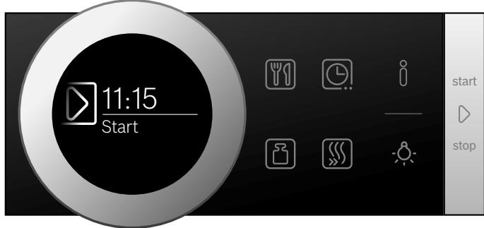
El aparato se encuentra en el modo de espera. Cuando el aparato inicia el funcionamiento, en la pantalla se muestra el transcurso de la duración.
