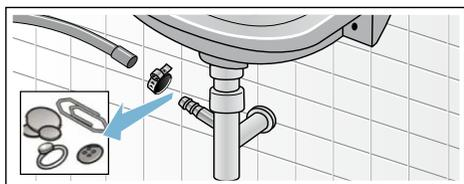
4. Подсоедините сливной шланг и зафиксируйте место соединения хомутом крепления шланга.
