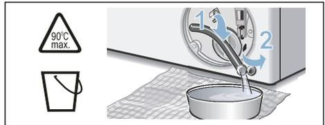
5. Осторожно отверните крышку насоса и выпустите остатки воды. Очистите внутреннюю поверхность, резьбу крышки насоса и корпус насоса. Прочистите насос внутри, резьбу крышки насоса и корпус насоса (лопастное колесо откачивающего насоса должно свободно вращаться). Установите крышку насоса на место и заверните её. Ручка должна находиться в вертикальном положении.
