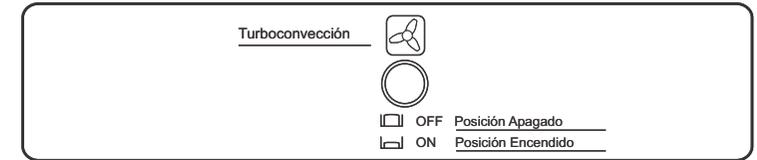
Este sistema permite cocinar uniformemente todo tipo de alimentos. La circulación forzada del aire caliente aumenta la transferencia del calor a los alimentos, permitiendo el aprovechamiento de toda la capacidad del horno, ya que permite cocinar a temperaturas menores de lo habitual.
