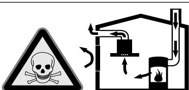
Vuurbronnen die de lucht in de ruimte verbruiken (bijv. apparaten die op gas, olie, hout of kolen worden gestookt, geisers, warmwaterketels) trekken de verbrandingslucht uit de opstellingsruimte en voeren de gassen via een afvoer (bijv. schoorsteen) af naar buiten.
