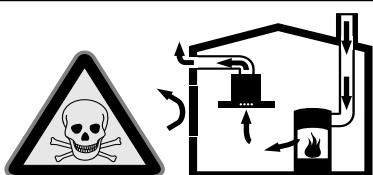
Les foyers à combustion alimentés en air ambiant (par exemple appareils de chauffage, au gaz, au bois, au fioul ou au charbon, les chauffe-eau, chauffe-eau accumulateurs) prélèvent l'air de combustion dans la pièce où ils sont installés et rejettent les gaz de fumée à l'extérieur par le biais d'un système spécifique (cheminée par exemple).
