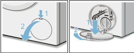
4. Staccare il tubo flessibile di svuotamento dal suo alloggiamento. Estrarre il tappo di chiusura. Fare scorrere l'acqua in un idoneo contenitore. Applicare il tappo di chiusura e ricollocare il tubo flessibile di svuotamento nel suo alloggiamento.
