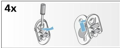
2. Inserire tutte le 4 boccole. Fissare il cavo di alimentazione nei fermi. Reinserire le viti dei blocchi per il trasporto e fissarle con una chiave inglese da 13.
