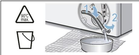
5. Svitare con cautela il coperchio della pompa, l'acqua residua può fuoriuscire. Pulire l'interno, la filettatura del coperchio della pompa e il corpo della pompa. L'elica della pompa di scarico dell'acqua deve poter girare liberamente. Applicare di nuovo il coperchio della pompa e serrarlo a fondo. L'impugnatura deve essere in posizione verticale.
