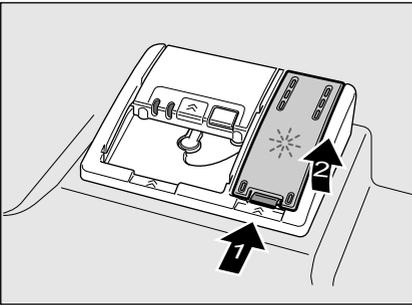
2. Versez doucement le liquide de rinçage ; il doit arriver jusqu'au repère de maximum sur l'orifice de remplissage.
