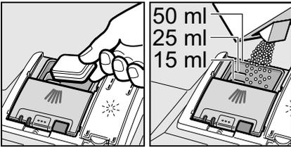
2. Poussez le couvercle du compartiment à détergent vers le haut jusqu'à ce que la fermeture enclante bien.
