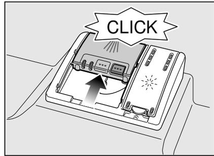
Le compartiment à détergent s'ouvre automatiquement au moment optimal, en fonction du programme. Le détergent en poudre ou liquide se répartit dans l'appareil et se dissout, la pastille tombe dans la coupelle interceptrice de pastille et s'y dissout de façon dosée.
