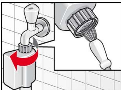
Si la lavadora-secadora no recibe el agua necesaria, eliminar la presión de agua del tubo de alimentación:
