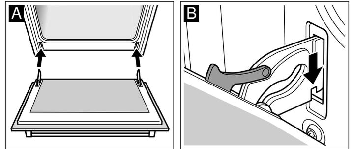
Se le cerniere non sono montate correttamente, può verificarsi un disallineamento della porta.
