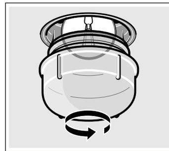
3. Sostituire la lampada con una di tipo simile.
