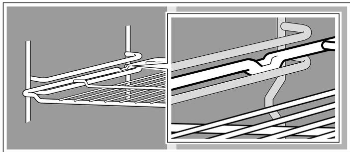
A seconda della dotazione dell'apparecchio, se disponibili, le guide telescopiche si bloccano leggermente quando vengono estratte completamente. In questo modo, l'accessorio può essere collocato con facilità. Per sbloccare, introdurre nuovamente le guide telescopiche nel forno esercitando una leggera pressione.
