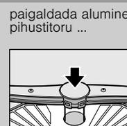
paigaldada alumine pihustitoru ...
