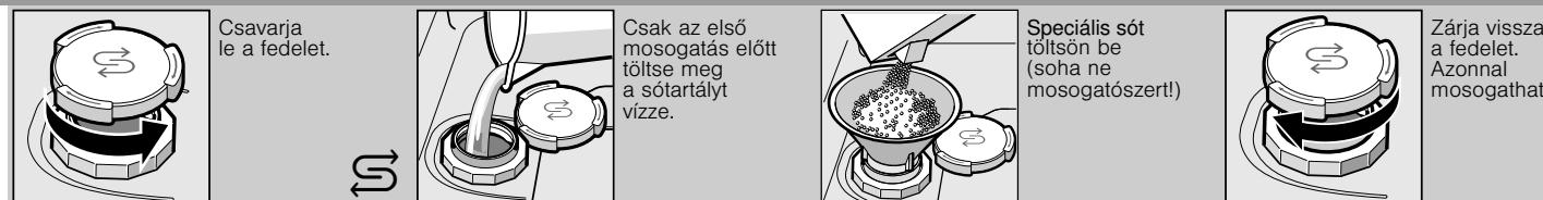
Vízkőoldás (a 0 beállítási érték esetén szükségtelen!) ...
