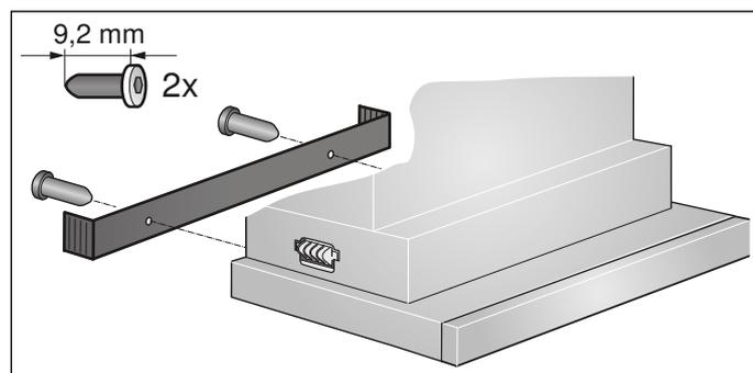
5. Premere il bullone di fissaggio e ruotare di 90°. **Avvertenza:** Gli elementi di fissaggio a sinistra e a destra dell'apparecchio devono essere mobili.
