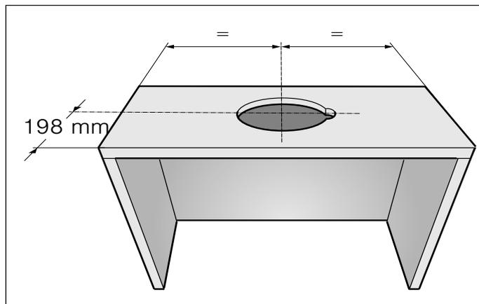
2. Se presente, rimuovere la base del mobile. Contrassegnare i punti di fissaggio sulle pareti interne del mobile e incidere con un bulino. Per contrassegnare i punti di fissaggio utilizzare l'elemento di fissaggio in dotazione.
