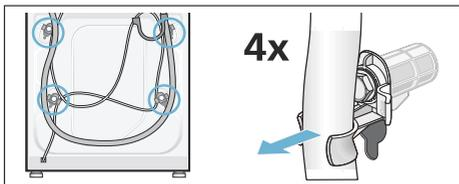
2. Dévissez les 4 cales de transport au complet et retirez-les. Enlevez les douilles. Sortez le cordon électrique de ses fixations.
