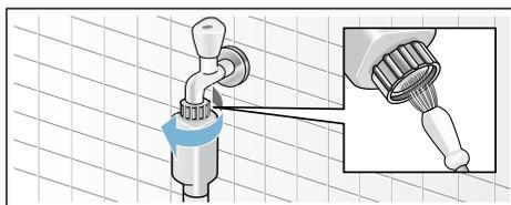
6. Nettoyage du filtre à l'arrière de l'appareil sur les modèles Standard et Aqua-Secure : Retirer le flexible au dos de l'appareil, Extraire le filtre avec une pince et le nettoyer.
