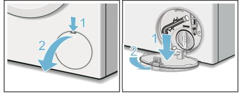
4. Sortez le flexible de vidange de son support. Retirez le bouchon de fermeture, laissez le bain lessiviel s'écouler dans un récipient adéquat. Enfoncez le bouchon de fermeture et mettez le flexible de vidange en place dans le support.
