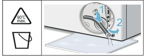
5. Dévissez délicatement le bouchon de la pompe ; de l'eau résiduelle peut s'écouler. Nettoyez le compartiment intérieur, le filetage du couvercle de pompe et le carter de pompe. Le rotor de la pompe de vidange doit pouvoir tourner librement. Remettez le couvercle en place et vissez-le. La poignée doit se trouver à la verticale.
