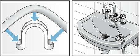
■ **Écoulement dans un siphon**
