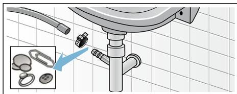
4. Rebrancher le tuyau d'évacuation et sécuriser le point de raccordement à l'aide du collier du flexible.
