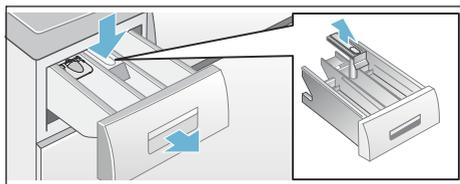
3. Avec de l'eau et une brosse, nettoyez le bac d'introduction du produit et l'insert, puis séchez-le. Éliminer aussi les résidus de produit lessiviel ou de produit assouplissant dans le corps.
