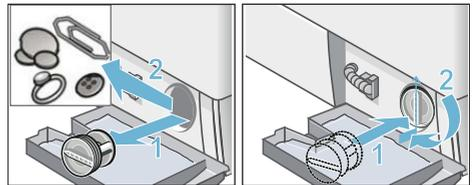
6. Remettre la trappe de service en place, l'encliqueter et la refermer.
