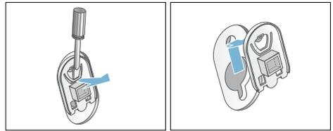
2. Insérez les quatre douilles. Clipsez solidement le câble d'alimentation sur les supports. Introduisez les vis et serrez-les.
