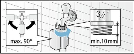
Ouvrir prudemment le robinet d'eau et vérifier en même temps si le raccordement est étanche.
