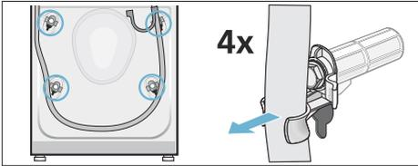
2. Retirez le câble d'alimentation des supports. Dévissez et retirez les quatre vis des sécurités de transport. Retirez les douilles.
