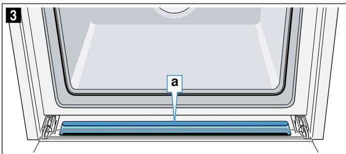
**Remarque :** Si le joint s'est détaché, remplacez le joint sur la gouttière. → "Porte de l'appareil" à la page 31
