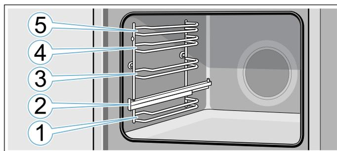
Aux niveaux d'enfournement 1, 3, 4 et 5, introduire l'accessoire toujours entre les deux barres de guidage d'un niveau d'enfournement.
