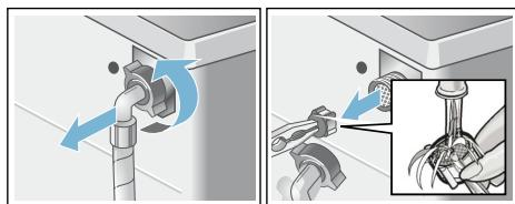
3. Raccorder le flexible et vérifier son étanchéité.
