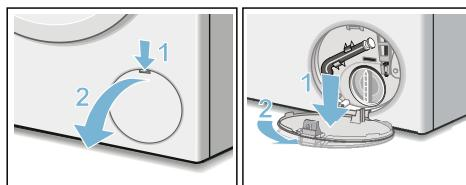
4. Sortir le flexible de vidange de sa fixation. Retirer la coiffe d'obturation, laisser le bain lessiviel s'écouler dans un récipient adéquat. Enfoncer la coiffe d'obturation et mettre le flexible de vidange en place dans la fixation.
