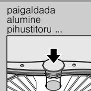
paigaldada alumine pihustitoru ...
