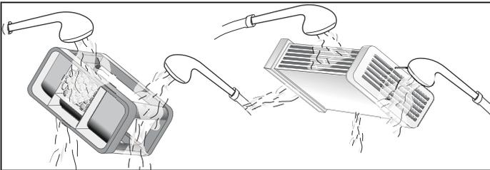
8. Enlevez les peluches et la charpie sur les joints de la sècheuse et de l'échangeur thermique.
