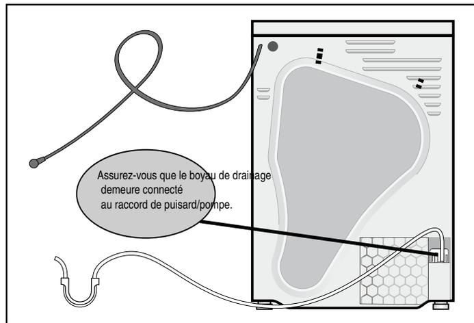
**AVIS :** Ne réutilisez pas un tuyau de drainage usagé ou un tuyau différent. Utilisez seulement le tuyau de drainage compris avec la sècheuse.
