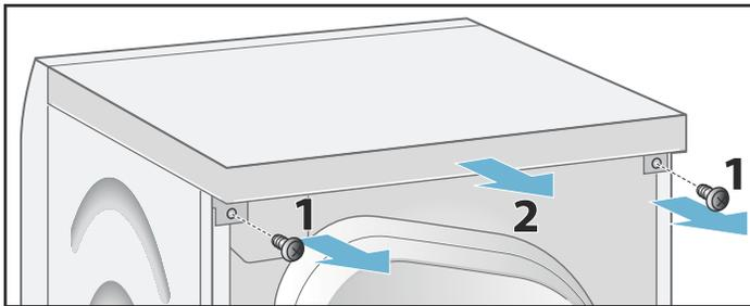
3. Ouvrez la boîte de connexion vers l'arrière de l'appareil en retirant la vis à tête torx T20 fixant le couvercle.
