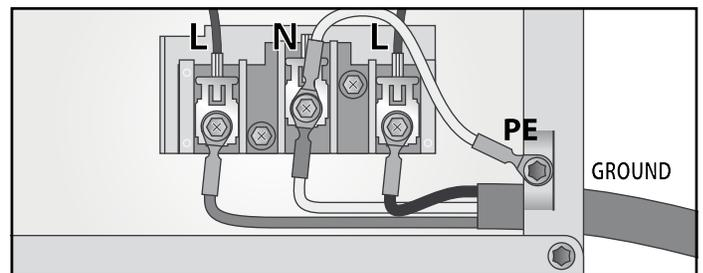
13. Serrez la vis de décharge de traction en s'assurant que le cordon d'alimentation ne peut être sorti de la boîte de connexion, mais ne serrez pas trop afin d'éviter de couper l'isolant du cordon d'alimentation.
