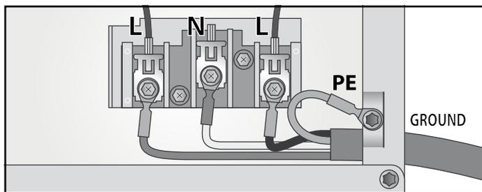
5. Desserrez la vis de collier de décharge de traction (tête Philips) à l'arrière de la boîte de connexion.
