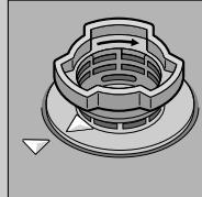
kierrä siiviläjärjestelmä kiinni. HUOMIO MERKIT!
