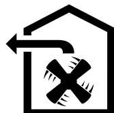
Vsesan zrak očisti maščobni filter in skozi sistem cevi se odvede na prosto.
