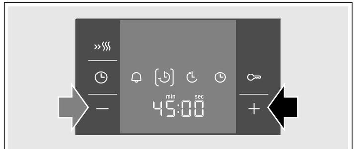
Au bout de quelques secondes, le four s'allume. Le symbole
