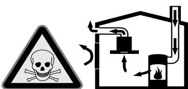
Vuurbronnen die de lucht in de ruimte verbruiken (bijv. apparaten die op gas, olie, hout of kolen worden gestookt, geisers, warmwatertoestellen) trekken de verbrandingslucht uit de opstellingsruimte en voeren de gassen via een afvoer (bijv. schoorsteen) af naar buiten.
