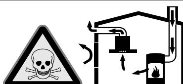
Les foyers à combustion alimentés en air ambiant (par exemple appareils de chauffage, au gaz, au bois, au fioul ou au charbon, les chauffe-eau, chauffe-eau accumulateurs) prélèvent l'air de combustion dans la pièce où ils sont installés et rejettent les gaz de fumée à l'extérieur par le biais d'un système spécifique (cheminée par exemple).
