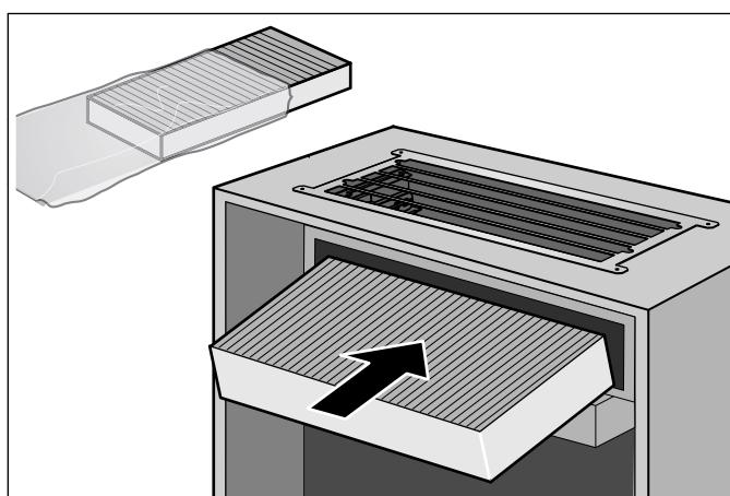
4. Ugradite metalni filter za mast.
