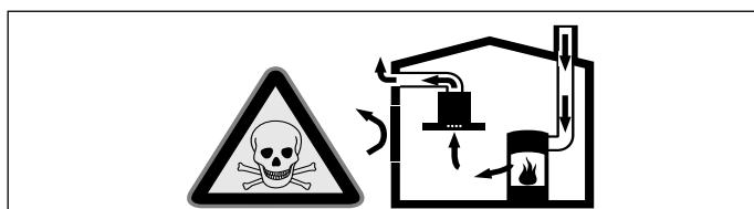
Vatrišta koja zavise od vazduha u prostoriji (npr. grejni uređaji na gas, ulje, drvo ili ugalj, protočni bojeri, kotlovi za zagrevanje vode) vazduh za sagorevanje crpe iz prostorije u koju su postavljeni i izduvne gasove izbacuju preko sistema za izduvne gasove (npr. kamoin) u spoljašnju sredinu.
