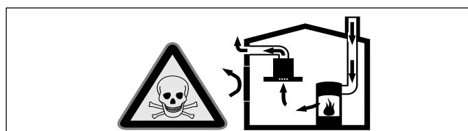
Kuhalisča, ki so odvisna od prostorskega zraka (npr. grelne naprave na plin, olje, les ali oglje, pretočni grelniki, bojlerji), jemljejo zrak za izgorevanje iz prostora postavitve in odvajajo dim prek sistema za odvajanje dima (npr. napa) na prosto.
