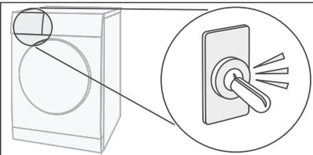
L'eau de condensation est évacuée par une pompe vers le réservoir d'eau de condensation. D'où les bruits de pompe.
