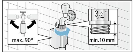
**Remarque :** Ouvrez prudemment le robinet d'eau et vérifiez en même temps si les raccords sont étanches. La jonction par vis se trouve sous la pression régnant dans la conduite d'eau.
