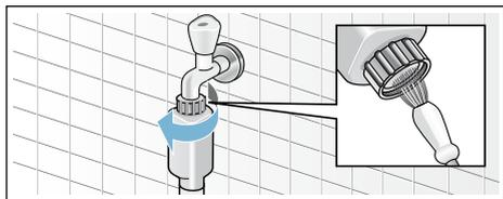
6. Nettoyage du filtre à l'arrière de l'appareil sur les modèles Standard et Aqua-Secure : Retirez le flexible au dos de l'appareil, Extrayez le filtre avec une pince et nettoyez-le.
