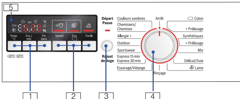
**1** Temp. °C (Temps restant), Ess./min (Essorage), Fin dans pour modifier les préréglages des programmes
