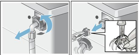
7. Schlauch anschließen und auf Dichtigkeit prüfen.
