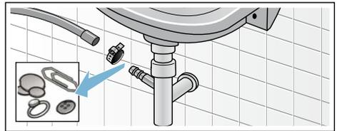
4. Ablaufschlauch wieder aufstecken und Anschluss-Stelle mit Schlauchschelle sichern.
