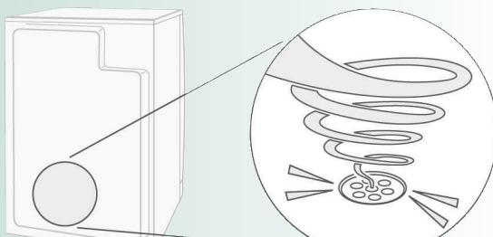
В процессе закачивания конденсата в резервуар для конденсата слышен звук работы насоса.
