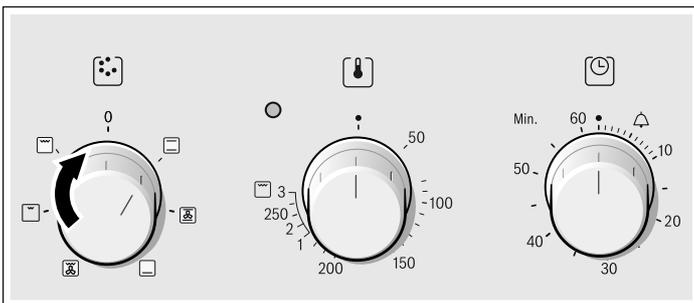
2. Servendosi del selettore della temperatura, è possibile impostare la temperatura o il livello del grill.
