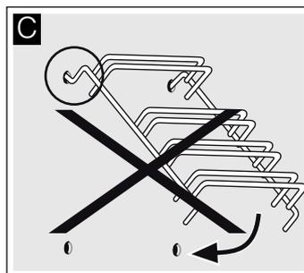
2. I due ganci devono essere completamente fissati nei due fori superiori. Ora muovere con cautela e lentamente il supporto verso il basso e agganciarlo nei due fori inferiori (Fig. D).
