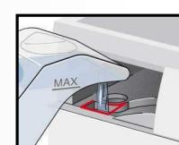
5. Reinserire completamente il contenitore dell'acqua di condensa.
