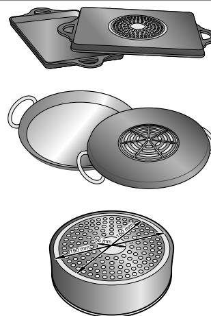
Då du använder stora kokkärl med en mindre ferromagnetisk diameter, värmes endast det ferromagnetiska området, vilket innebär att värmefördelningen kanske inte blir jämn.
