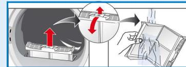
3. Удалите ворс, промойте обе части ворсового фильтра под струей воды и тщательно высушите.
