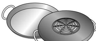
Les récipients à zones d'aluminium dans la base diminuent la surface ferromagnétique ; la puissance fournie peut donc être moins importante, il peut y avoir des problèmes de détection du récipient et il pourrait même ne pas être détecté.
