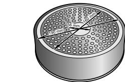
Afin d'obtenir de bons résultats de cuisson, le diamètre de la surface ferromagnétique doit, de préférence, être adapté à la taille de la zone de cuisson. Si le récipient n'est pas détecté sur une zone de cuisson, l'essayer sur la zone de diamètre immédiatement inférieure.
