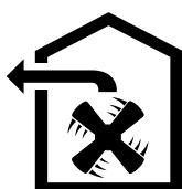
Vsesan zrak očisti maščobni filter in skozi sistem cevi se odvede na prostoto.
