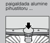
paigaldada alumine pihustitoru ...
