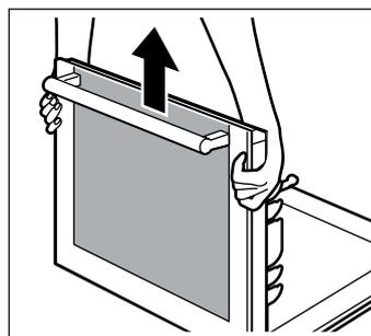
Bauen Sie nach der Reinigung die Backofentür wieder ein, indem Sie denselben Schritten in umgekehrter Reihenfolge folgen.
