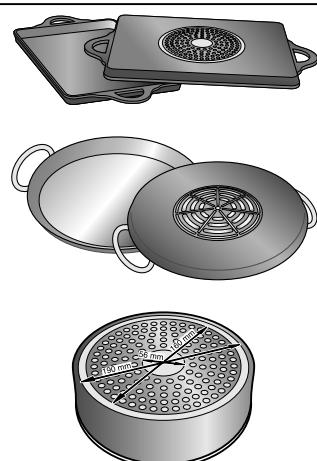
Bij het gebruik van grote pannen met een ferromagnetische zone met een kleinere diameter, wordt enkel de ferromagnetische zone verwarmd, zodat de warmte niet homogeen kan worden verdeeld.
