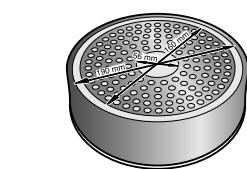
Per una buona cottura, è consigliabile che il diametro dell'area ferromagnetica del recipiente corrisponda alle dimensioni della zona di cottura. Se il recipiente non viene rilevato in una zona di cottura, provare nella zona di diametro immediatamente inferiore.
