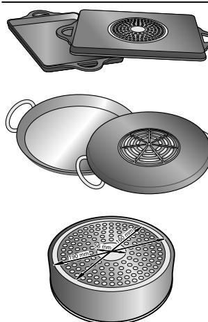
Ist der Boden des Kochgeschirrs nicht komplett ferromagnetisch, wird nur die magnetisierbare Fläche heiß. Dadurch kann es sein, dass die Wärme nicht gleichmäßig verteilt wird.
