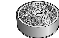
Afin d'obtenir de bons résultats de cuisson, le diamètre de la surface ferromagnétique doit, de préférence, être adapté à la taille de la zone de cuisson. Si le récipient n'est pas détecté sur une zone de cuisson, l'essayer sur la zone de diamètre immédiatement inférieure.
