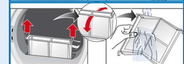
4. Zuklappen, Flusensiebe ineinander stecken und wieder einsetzen.
