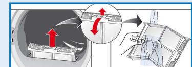
3. Flusen entfernen und beide Flusensiebe unter fließendem Wasser durchspülen und gut abtrocknen.
